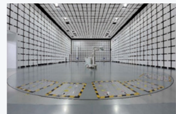
クオリティセンターの10m法対応電波暗室
