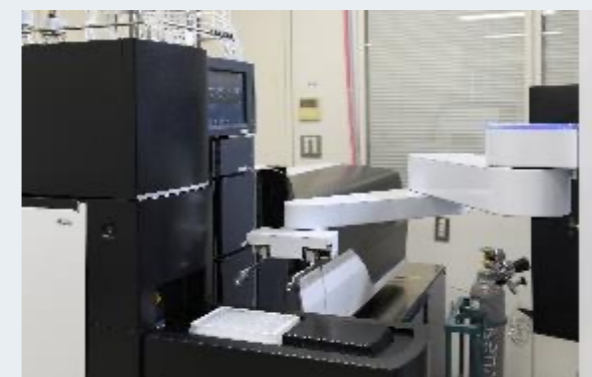
自律型実験システム(Autonomous Lab)のロボット対応液体クロマトグラフ
