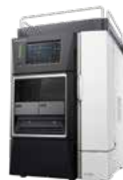
高速液体クロマトグラフ 質量分析システム
