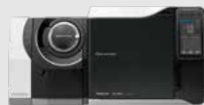
システム開発で使用している ガスクロマトグラフ質量分析計 「GCMS-QP2020NX」
