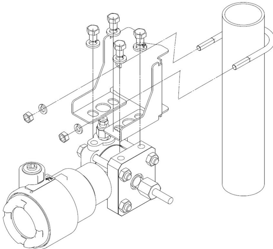
図 5 - 1 伝送器の取付け (T250K 標準)
