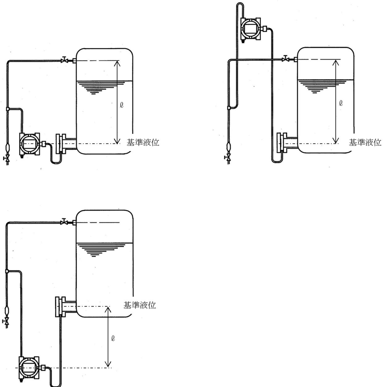
図5-10 プロセス接続（密閉タンク）
