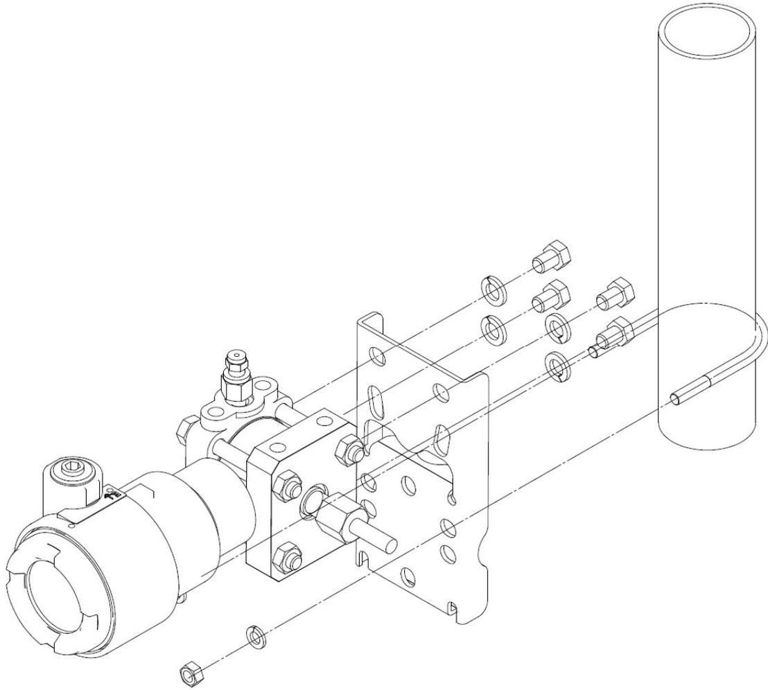
図 5 - 2 伝送器の取付け (T250K\_\_\_\_-FT)
