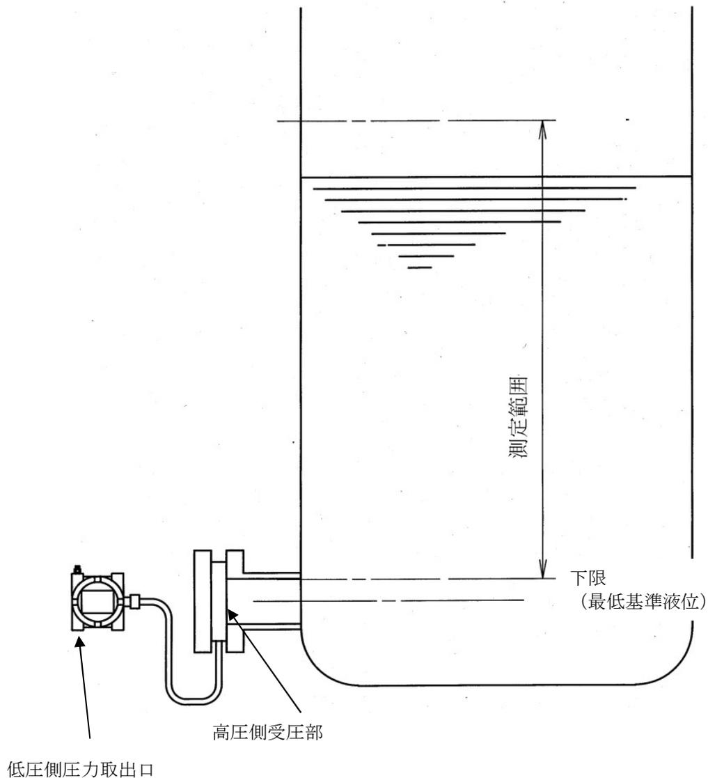
図5-11 プロセス接続（開放タンク）
