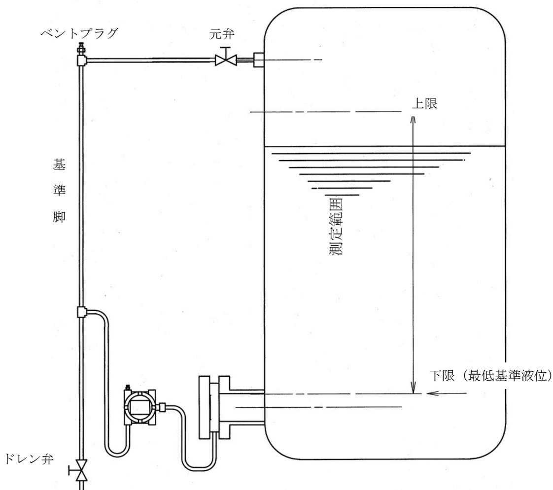
図5-13 プロセス接続（密閉タンク—ウェット・レグ）
