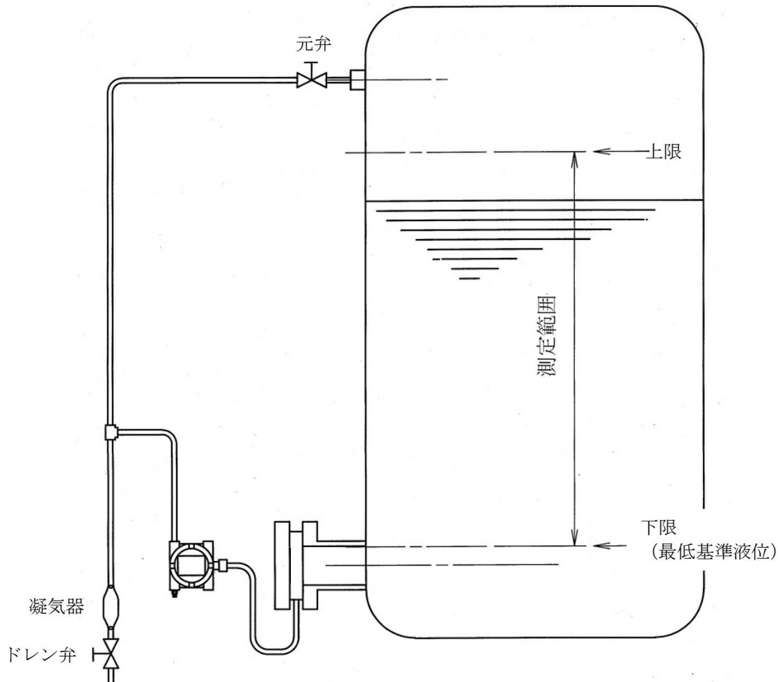
図5-12 プロセス接続（密閉タンクードライ・レグ）
