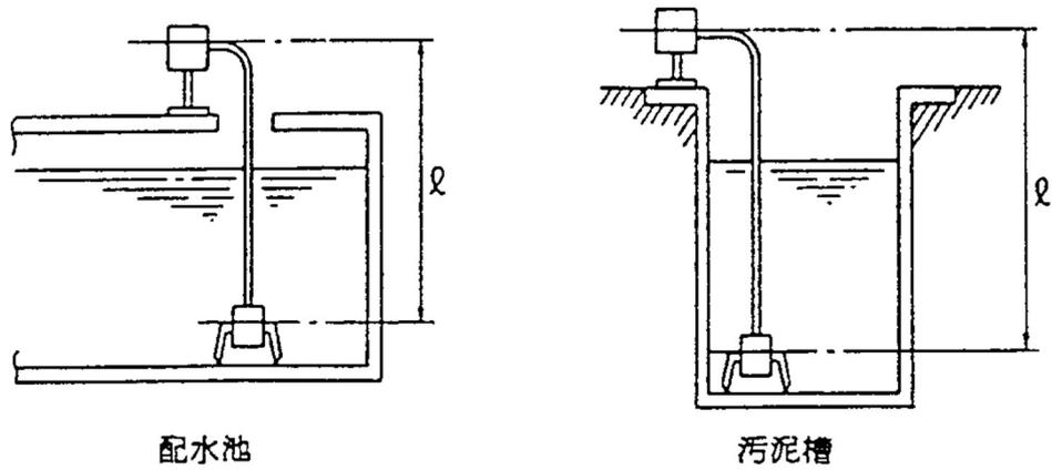
図 5 - 1 4 投込み式伝送器
