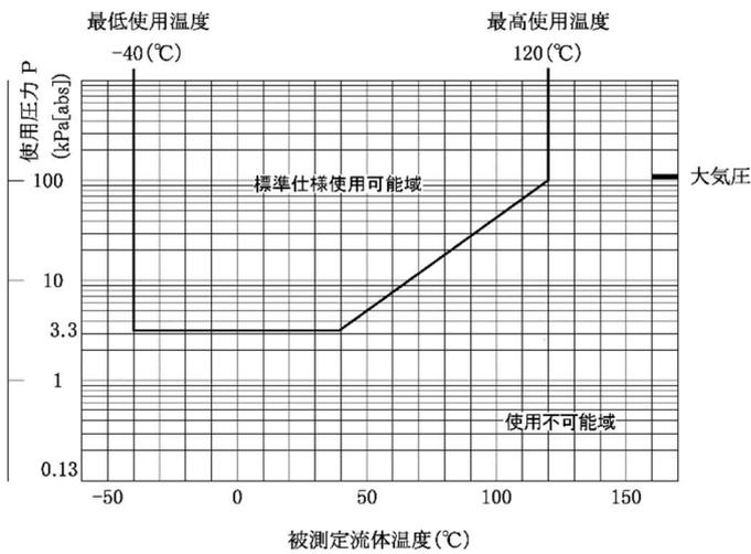
図 4-2 使用圧力と接液温度 (低压側)
