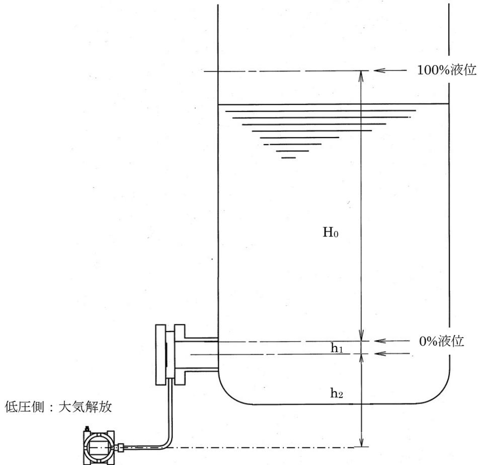
図6-1 開放タンクの液位測定配管
