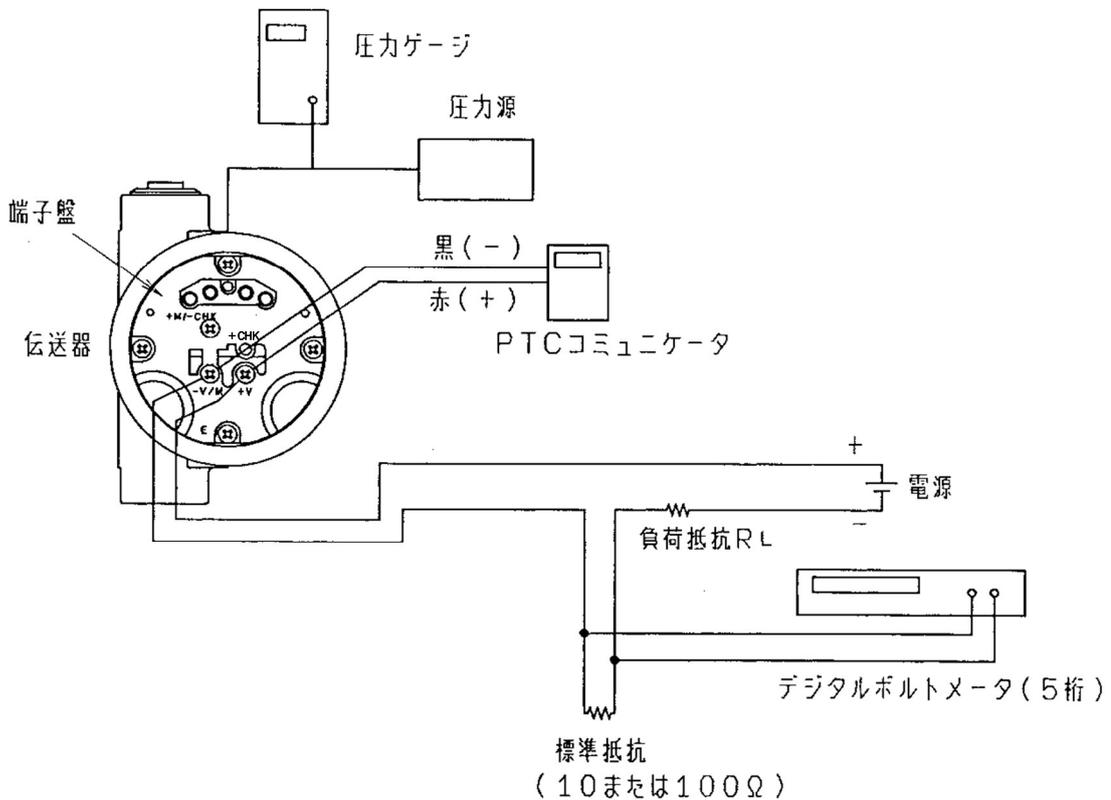
注)  $(R_L + \text{標準抵抗}) > 250\Omega$  が必要です。電源電圧と負荷抵抗の関係は図4-1に示す範囲内としてください。
