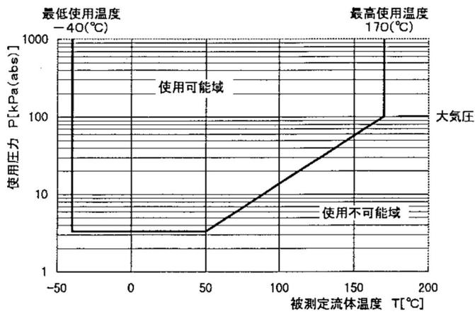
図 4-1 使用圧力と接液温度 (高压側)
