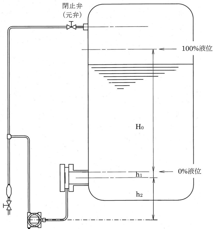
図6-2 密閉タンクの液位測定配管（ドライ・レグの場合）
