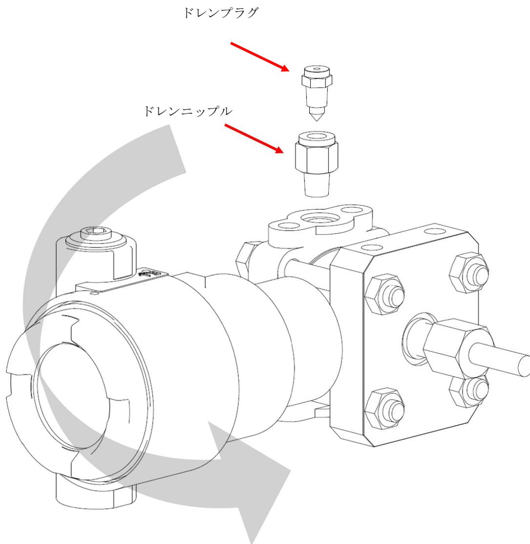
図5-3 圧力導入口の変更
