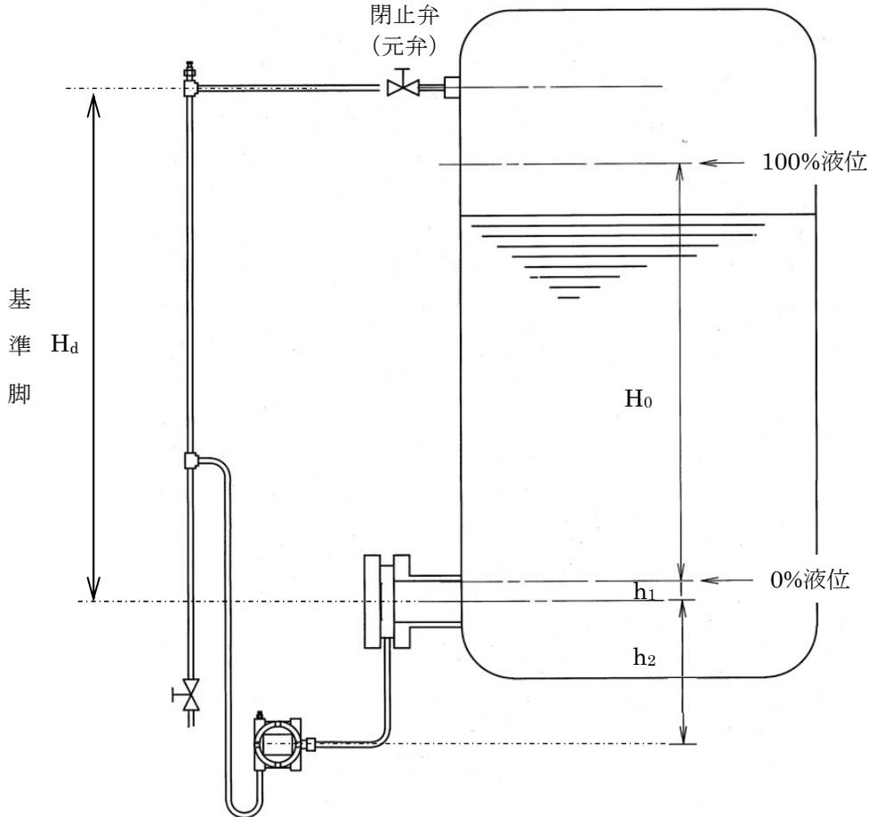
図6-3 密閉タンクの液位測定配管（ウェット・レグの場合）
