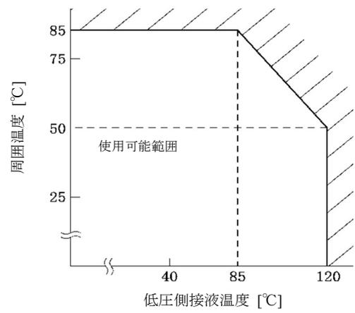
図 4-4 低压側接液温度と周囲温度
