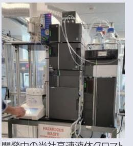
開発中の当社高速液体クロマトグラフを用いたフロー合成モニタリングシステム
