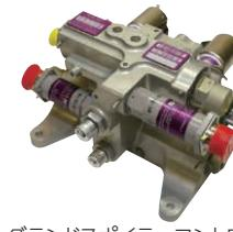
グランドスポイラーコントロールモジュール(B737MAX向け): 機体着陸の際、主翼にあるスポイラーの作動制御装置
