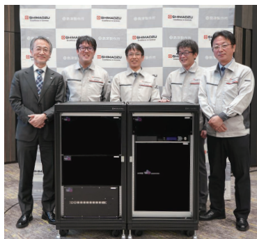
19インチラックに組み込んだ250リットル光格子時計
