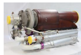
空調システム 機内の温度と圧力を調節。機内環境を総合的に最適化し、快適な環境を提供
