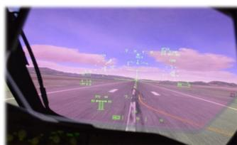
高度・速度・方位などの飛行情報を投影する装置。高度な電子技術と光学技術を駆使し、パイロットの負荷軽減、飛行安全に貢献
