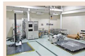
グローバル化への対応強化として、製品を輸送中に落下や衝撃があったとしても、安全な包装設計になっているかを確認するための落下試験装置を導入しました。
