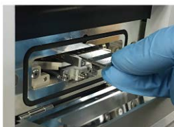
装置へ挿入し、待機(真空引き)
