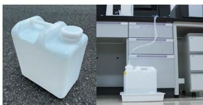
プラスチック梱包材を再生して作った廃液容器
