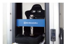
自動車シートの実物シミュレーション試験
