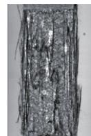
炭素繊維強化プラスチック(CFRP)の高速引張試験の撮像例
