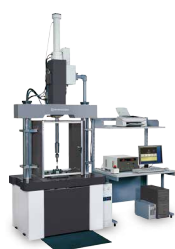
高速引張試験機 HITS-TX
