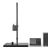
超音波光探傷装置 MAIVIS MIV-X
