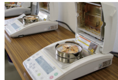
木質チップの含水率測定グラフと電子水分計 MOC63u
