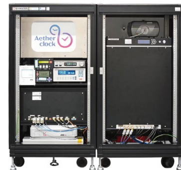
ストロンチウム光格子時計「Aetherclock OC 020」。小型化により実験室外での計測を可能にし、さらに自動復帰機能の搭載で従来、人手を要していた復帰作業を大幅に削減した。
