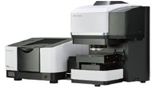
フーリエ変換赤外分光光度計IRXross™(左)と接続したAIMsight™(右)
