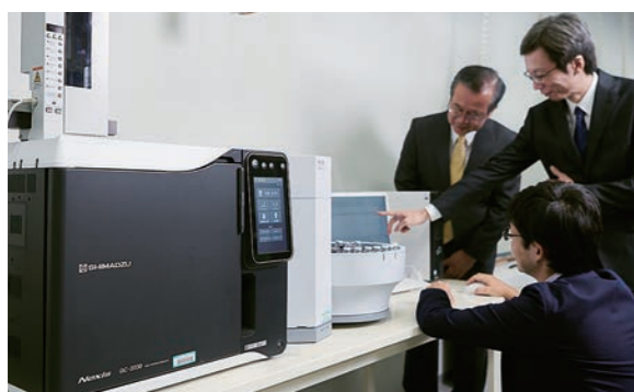
微生物から発生したガスを分析するための分析装置 写真は島津製作所製ガスクロマトグラフ Nexis GC-2030
