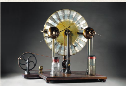
二代源蔵が15歳のときに完成させた感応起電機。高電圧を発生させる器械で、当時「島津の電気」として有名だった。
