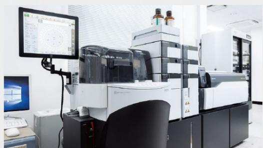
崔教授の研究室にある島津製作所の検体前処理装置CLAM-2000 CLと液体クロマトグラフ質量分析システムNexera LC-MS/MSシステム(LCMS-8050CL)。海外では研究用途だけでなく臨床現場にも質量分析計の導入が積極的に進められており、日本でも導入の可能性が広がっている。
