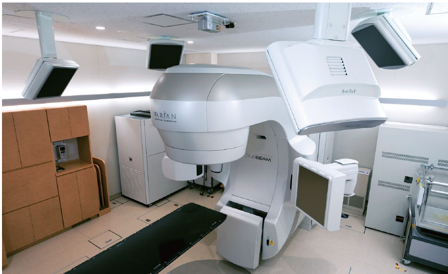
魚沼基幹病院に導入されている放射線治療装置と島津製作所の動体追跡システムSyncTraX FX4 version (天井に設置された4式の検出器/パネル部分)とX線管を搭載することで、大視野と高精細画像での治療部位の把握を可能にしている。
