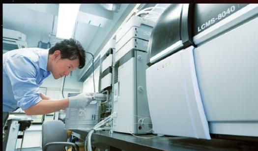
古川博士の研究に欠かせない愛機である島津製作所の高速度液体クロマトグラフ質量分析計LCMS-8040(超高速トリプル四重極型LC/MS/MS)
