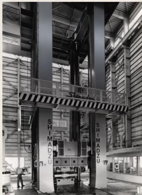
1975年に日本大学理工学部へ納入された当時の30MN（メガニュートン）大形構造物試験機（縦型）
