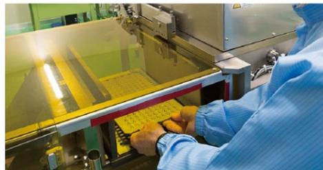
時計は、小さすぎてロボットアームでは扱えない。手作業でセットしてスパッタリング装置にかけていく。
