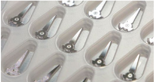
スパッタリングで成膜された時計の針。針の重さはムーブメントの負荷に関わるので、軽量化が強く求められていた。
