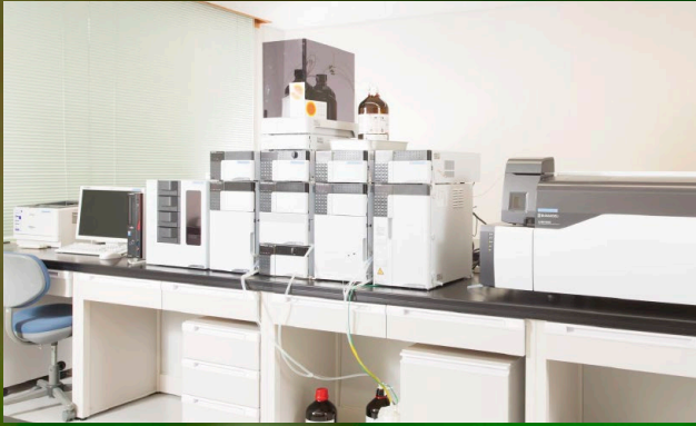
大阪大学、神戸大学、宮崎県と共同で島津製作所が開発した超高感度分析装置 超臨界流体抽出／超臨界流体クロマトグラフィシステム「Nexera UC」の1号機
