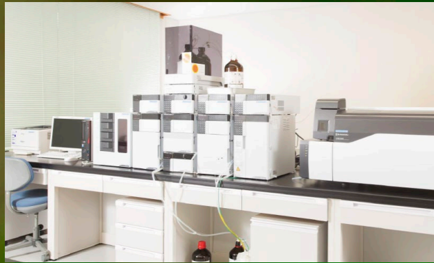
大阪大学、神戸大学、宮崎県と共同で鳥津製作所が開発した超高感度分析装置 超臨界流体抽出/超臨界流体クロマトグラフィシステム「Nexera UC」の1号機
