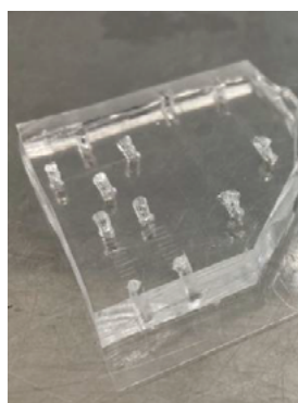
Fig. 3 顕微鏡観察下での細胞培養用のマイクロ流体デバイス
