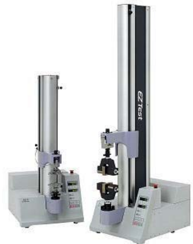
図1 小型卓上試験機 EZTest 外観図
