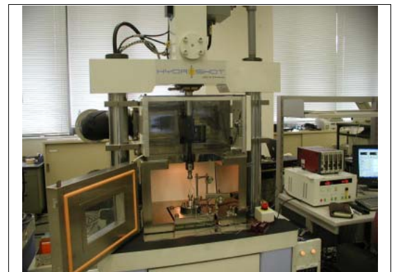
写真 1 高速引張り衝撃試験機 HITS-T10
