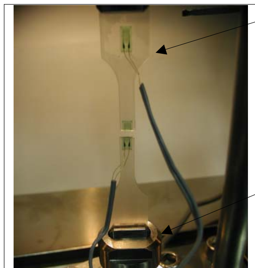
写真 2 破断後の試料とグリップ
