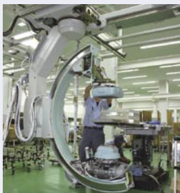
血管撮影システムの組み立て
