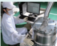
ターボ分子ポンプの性能試験
