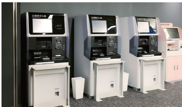
島津製作所の診療費支払機MERSYS-AR700。多言語対応に加え、人的ミスを防ぐことができるなど機能が多く、患者の利便性とスタッフの業務の省力化に貢献している。
