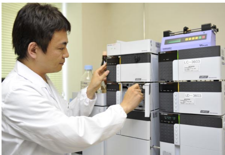
研究室では、島津製作所の高速度液体クロマトグラフ (HPLC) Prominence UFLC シリーズなどが多数稼働している
